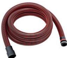
Ø interne de 32 mm, 4 m avec dispositif de connexion universelle, système de clip et adaptateur universel (320,188), antistatique. Avec recyclage de débit d'air grâce à l'adduction d'air additionnelle.
